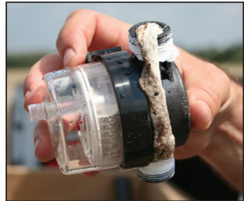
Figura 6. Limo filamentoso de azufre que tapa completamente un pequeño medidor de agua.
